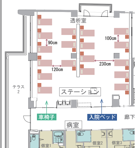
改修後：病室から水平移動だけで入室できる透析
