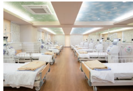
階高を抑えることで設けられた6階に新設した透析室。室内に柱を設けずに見通しを確保している。
