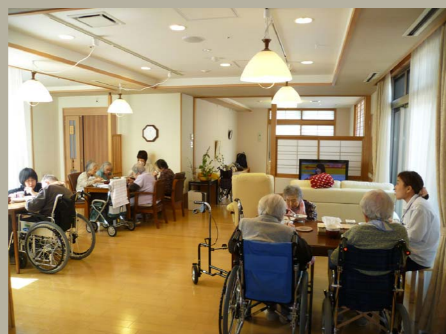
ユニット内共同生活室(リビング) 入居者の方が、お茶を飲んだりテレビを見たり食事をされる場所。家具のレイアウトにあわせて、照明器具の位置を変えられるようにレールやフックを取り付けている。障子や壁の凹凸などで、落ち着ける生活空間単位を構成できるように計画された。
