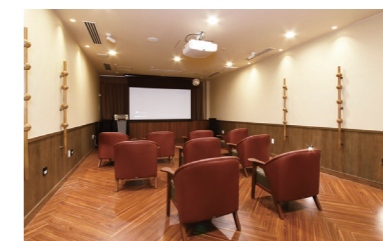
シアターで立位保持の機能訓練ができるように縦手摺を設置
