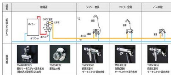
TOTO 大型サーモスタットの設置例
