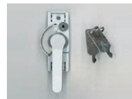
【キー付クレセント】 認知症の方など無理な力を加えられない場合は有効。器具等でクレセント自体を壊されると開けられるため補助的な対策
