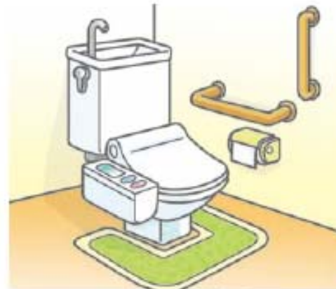
手すりの設置
