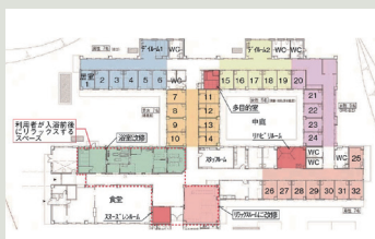
改修により日中を過ごす場所を目的別に設けたプラン
