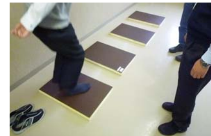
重すぎず壊れにくい建具をつくるための実験
